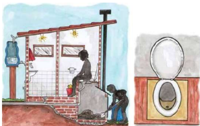
Figura 90 – Banheiro seco com bacia sanitária segregadora de urina
