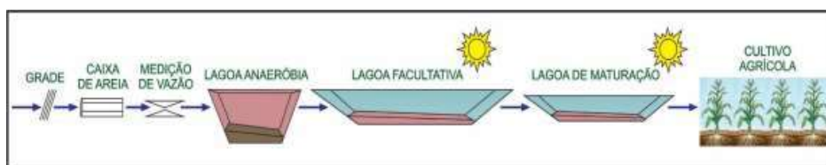
Figura 70 - Esquema de ETE composta por lagoa de estabilização
