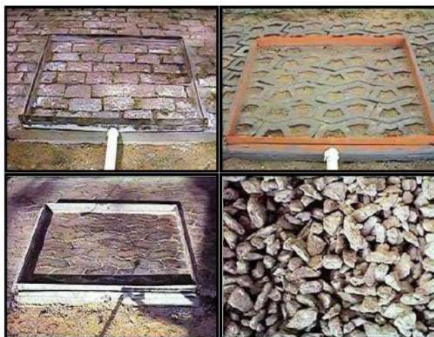
Figura 101 – Exemplos de pavimentos permeáveis
